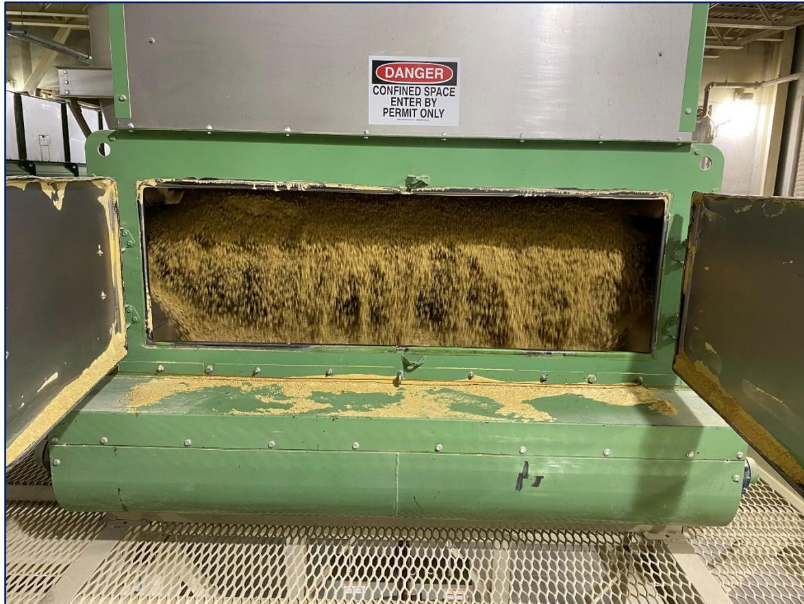
Toda la humedad introducida en el acondicionador durante el proceso de peletizado tiene que ser removida durante el proceso de enfriado /secado de los pelets.
