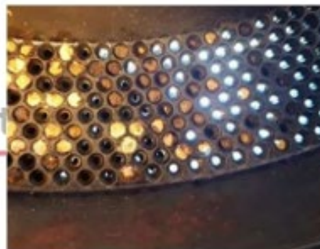
Luz debajo del troquel. Se requiere limpieza manual después del lavado a presión.
