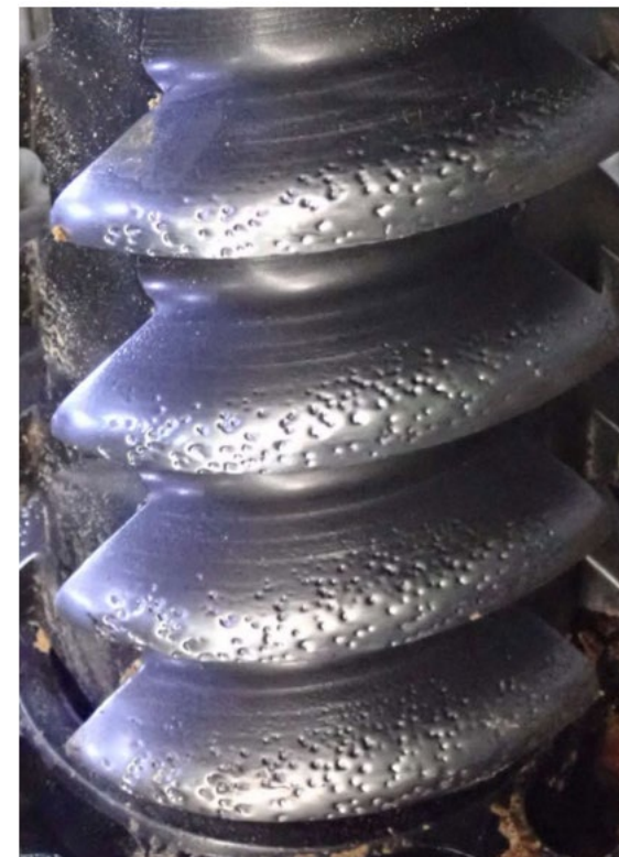
Tornillo cónico con desgaste excesivo.
