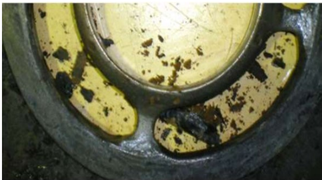
Cerradura estacionaria con desgaste excesivo entre las aberturas
